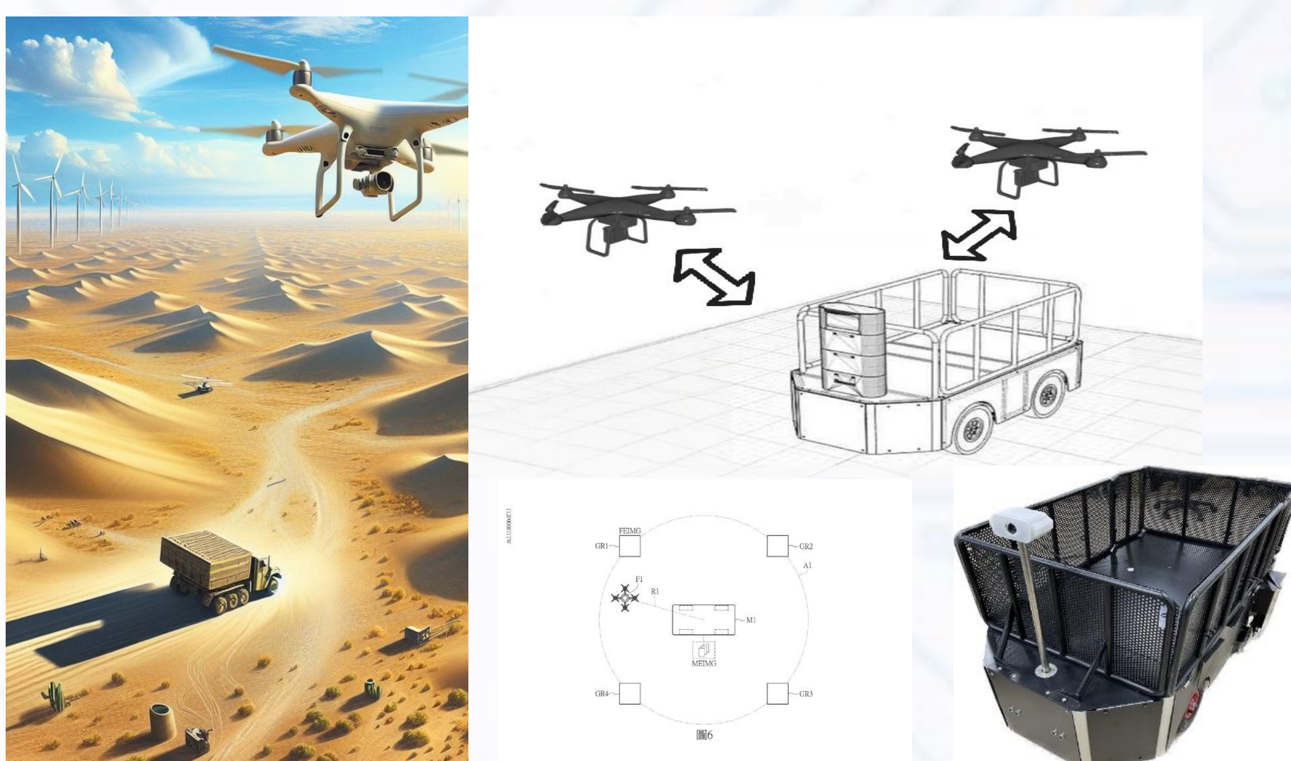
圖二、陸空協作設計圖(左)，自製之野地農用智慧自走車(右)
